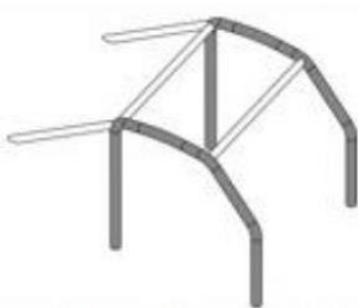
2 oldalsó bukócső 2 keresztmerevítő 2 hátsó megtámasztás
