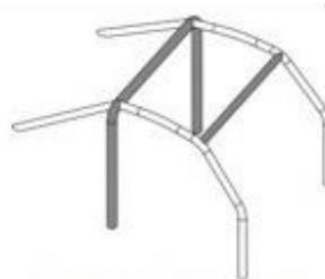
1 főbukócső 2 oldalsó félbukócső 1 keresztirányú merevítő member 2 hátsó megtámasztás
